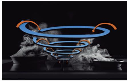
Grâce à sa conception, la zone d'aspiration du Flow5 produit un flux d'air à grande vitesse générant un effet d'attraction qui s'étend plus haut, attirant les fumées vers le centre et les conduit à l'intérieur.
